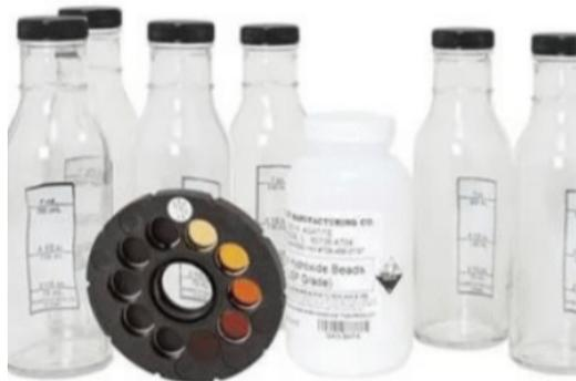
Cumple las siguientes especificaciones: ASTM C40; AASHTO T 21. Cinco frascos de prueba de impurezas graduados, una tabla de referencia de colores circular con cinco colores de referencia estándar. Frascos de prueba de impurezas graduados en 8 oz y 240 ml y tienen tapas de rosca. Tabla de referencia de colores con cinco colores de referencia permanentes 5, 8, 11, 14 y 16 en la escala Gardner. Incluye: Tabla de referencia de color
