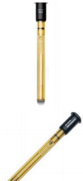
Para ISE de media celda Cumple las siguientes especificaciones: Electrodo de media celda potenciométrica que contiene una referencia de plata/ cloruro de plata (Ag/AgCl) alojada dentro de un cuerpo de plástico.
